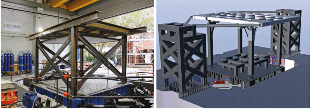
Fig.03 Telaio posizionato sulla tavola vibrante multiassiale per prova di risposta sismica di un controsoffitto. Archivio della Fondazione EUCENTRE
