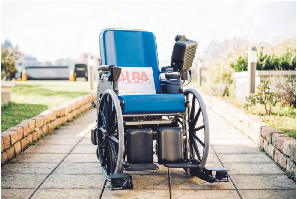
Fig.01 La sedia a rotelle a guida autonoma, risultato del progetto di ricerca A.L.B.A.
